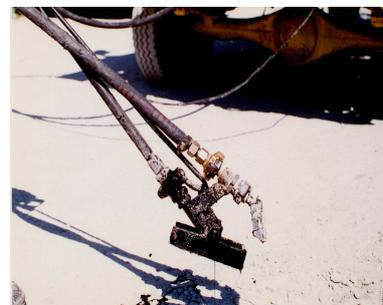
Sabot de pontage équipé d'une carpe de sablage automatique pour le cloutage du pontage
